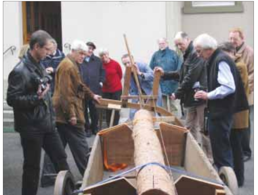
Es kann losgehen: Nachdem Stamm und Bohrer in der Höhe und seitlich ausgerichtet waren, konnte das Bohrblatt in den Stamm getrieben werden. Foto: rs
